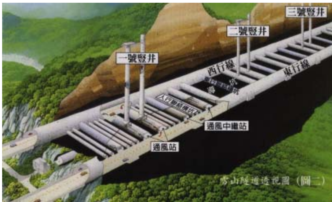
圖 4.1 雪山隧道通風系統透視圖
