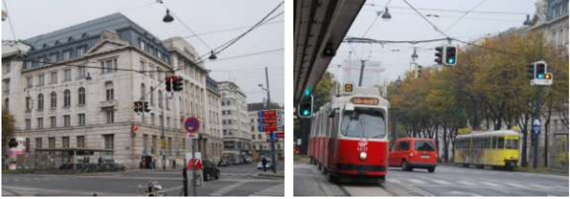
圖4.3.1利用天際空間設置懸掛式路燈、號誌
