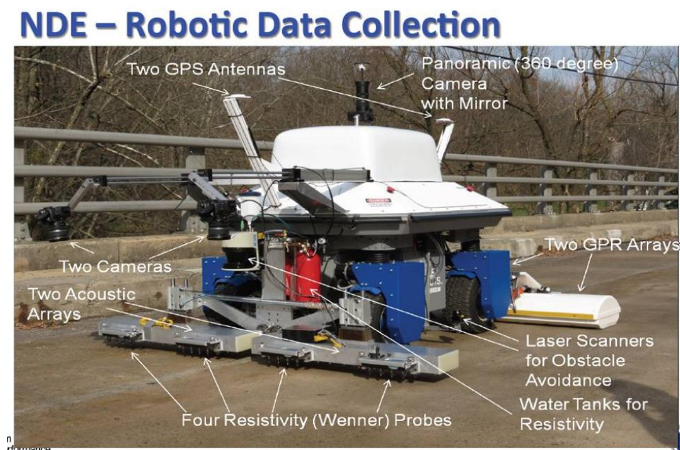
圖 4-2 非破壞性監測數據收集分析儀
