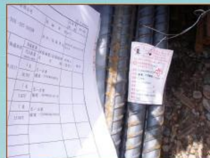
鋼筋取樣送驗
