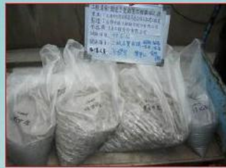
混凝土拌合粒料抽驗
