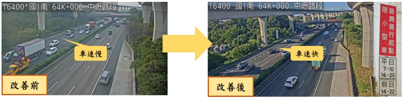
圖 9 國道 1 號北向平鎮系統至中壢開放路肩改善前後對照圖
