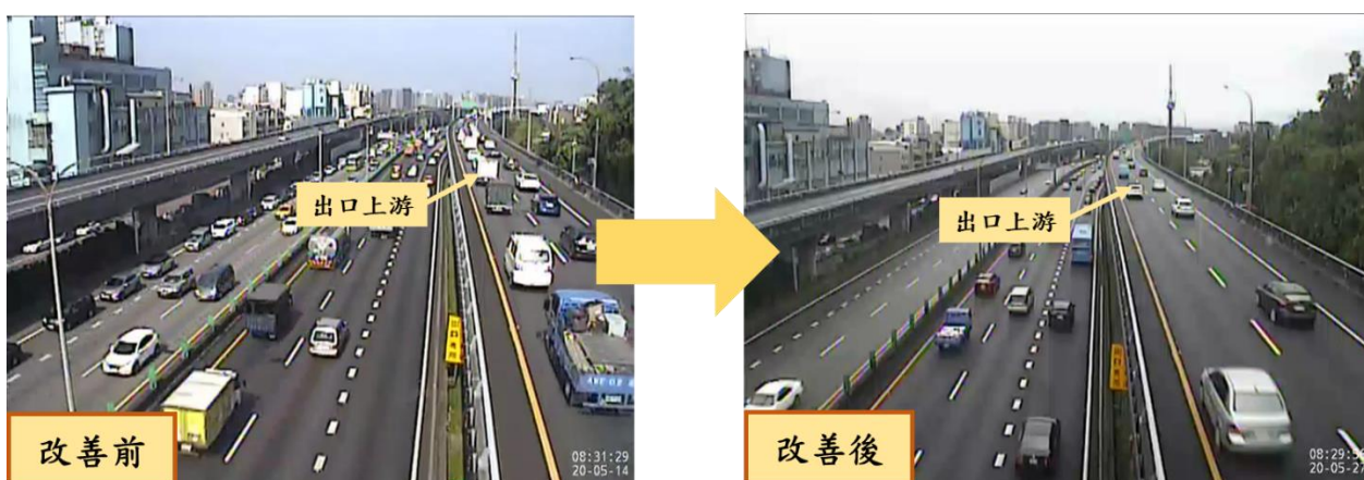
圖 5 國道 1 號高架堤頂交流道南向出口上游路段改善前後對照圖
