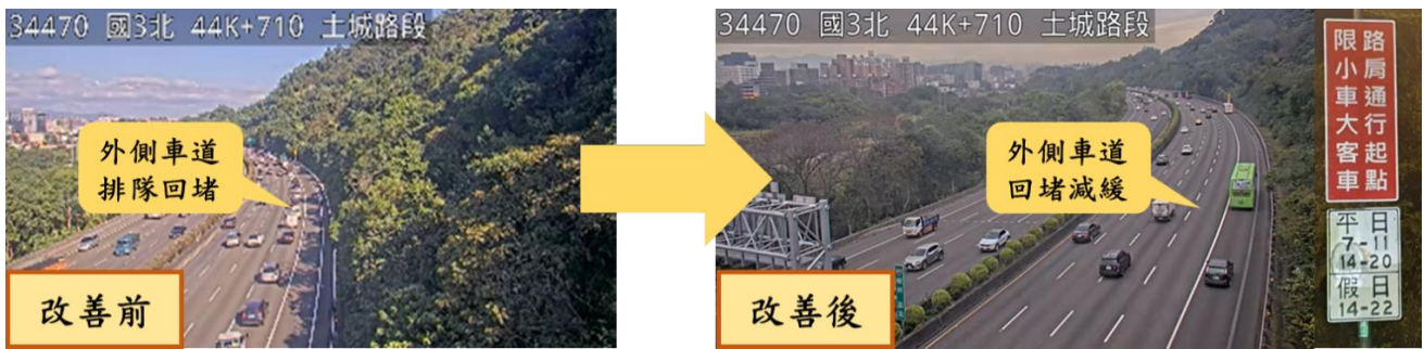
圖 16 國道 3 號北向樹林至土城開放路肩時段調整前後對照圖
