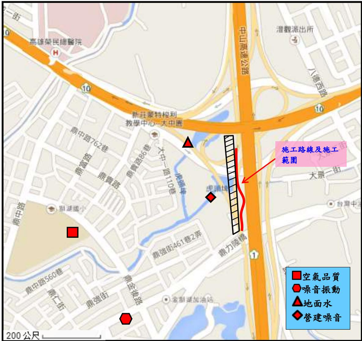
圖 1.4-1 『第二高速公路後續計畫(新營—屏東段)鼎金系統交流道增設鼎力路南下出口匝道改善工程』之各類監測點位置示意圖
