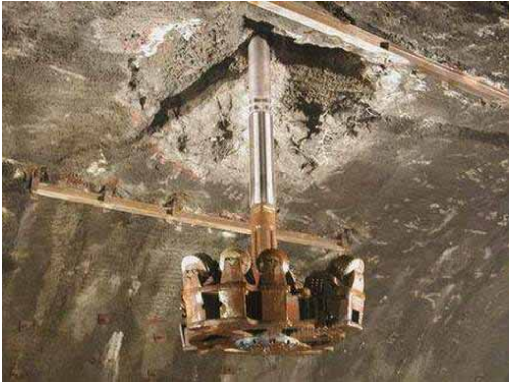
照片十三、昇井工法擴孔鑽頭
