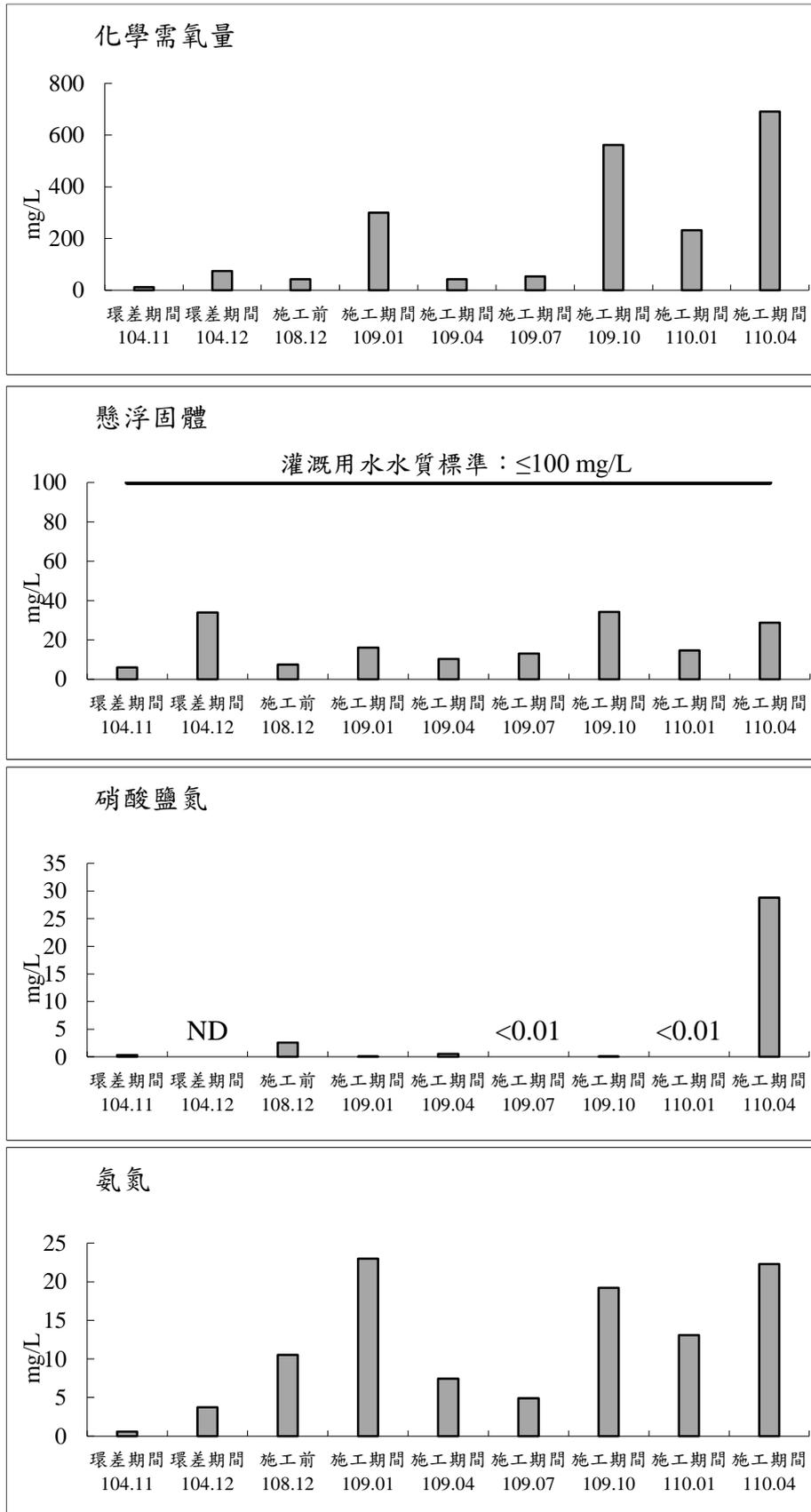
圖 2.3-2 八德分渠(工區上游)測站歷次地面水體水質監測之各項測值變化圖(續 1)
