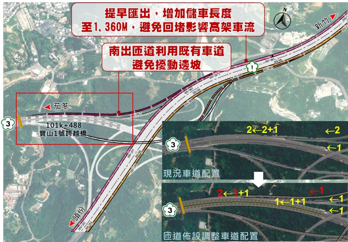
圖 4.1-24 新竹系統交流道基本方案配置示意圖
