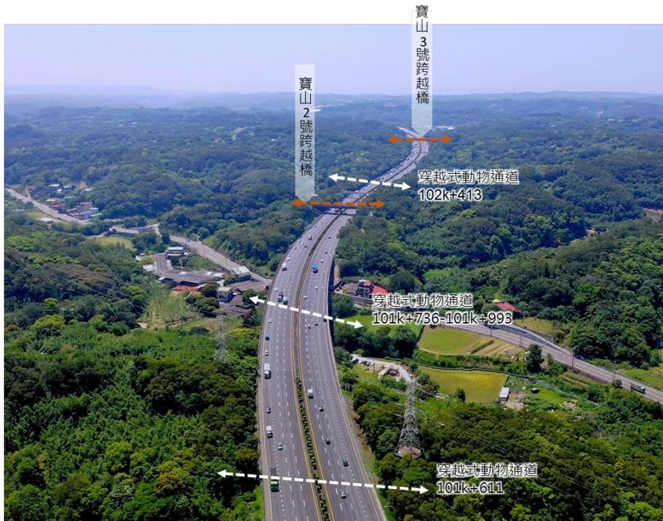
圖 4.1-22 國3新竹系統至茄荖交流道間動物通道布設示意圖
