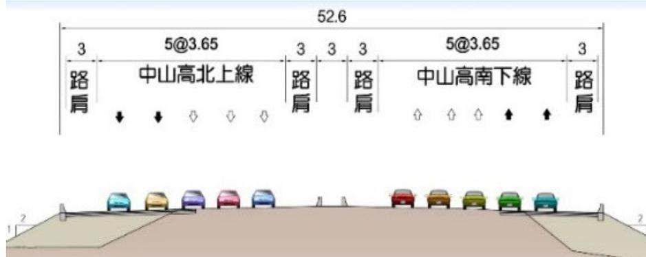
圖 4.1-3 湖口段路堤拓寬段斷面示意圖(可行性研究階段)
