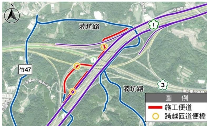
圖 4.3-24 新竹系統交流道施工動線圖
