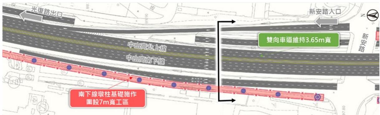
第一階段南下線施工
