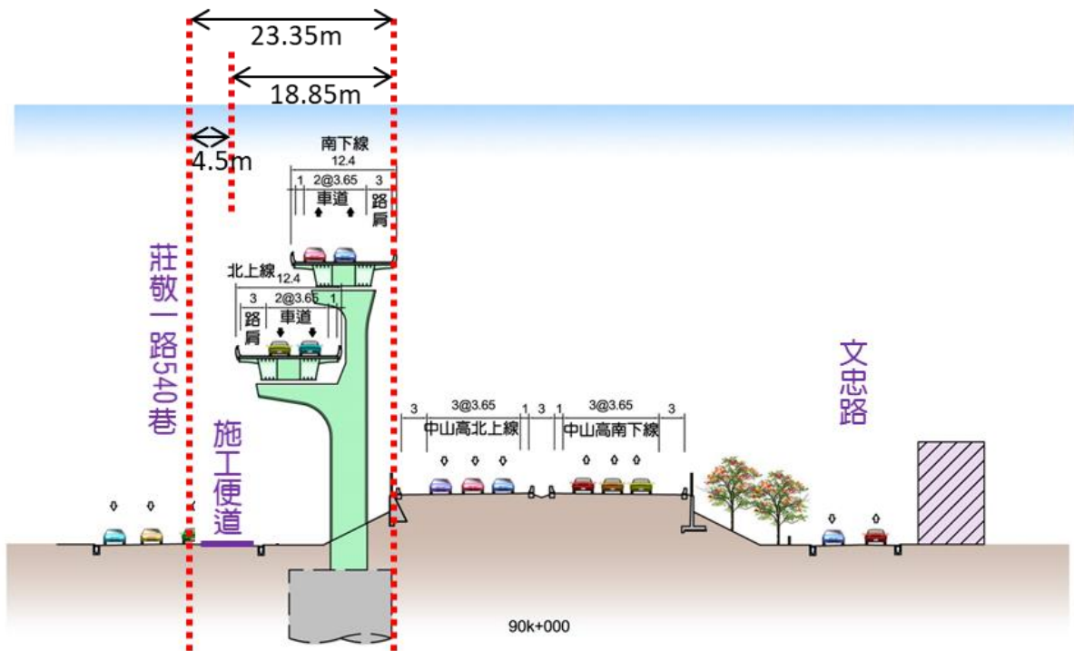
圖 16 東側雙層橋方案施工規劃及交通影響示意圖(勝利 7 街以北)
