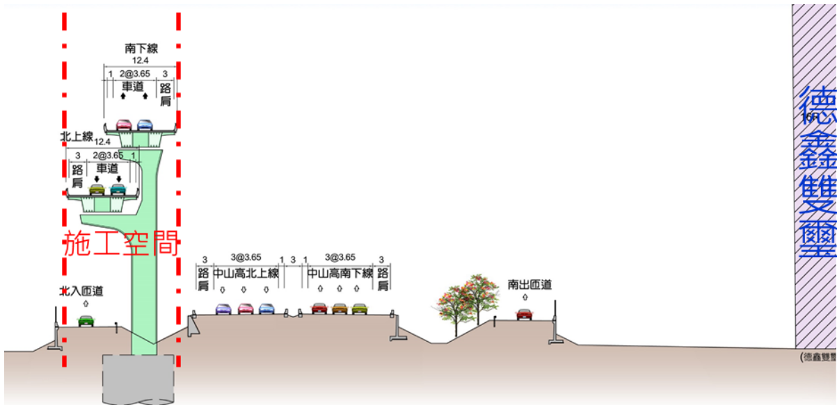
圖 18 東側雙層橋方案施工規劃及交通影響示意圖(勝利 7 街以南，德鑫雙壟社區處斷面)
