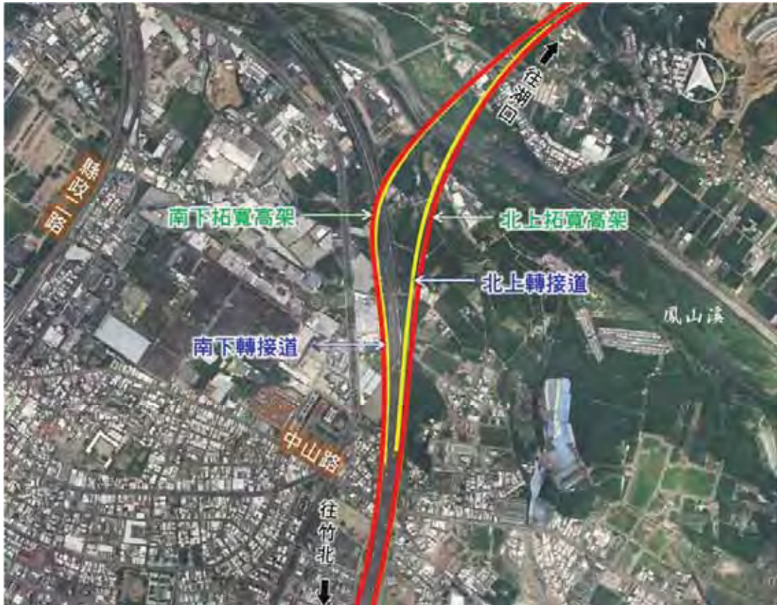
圖 5.2.3-5 竹北轉接道平面配置示意圖
