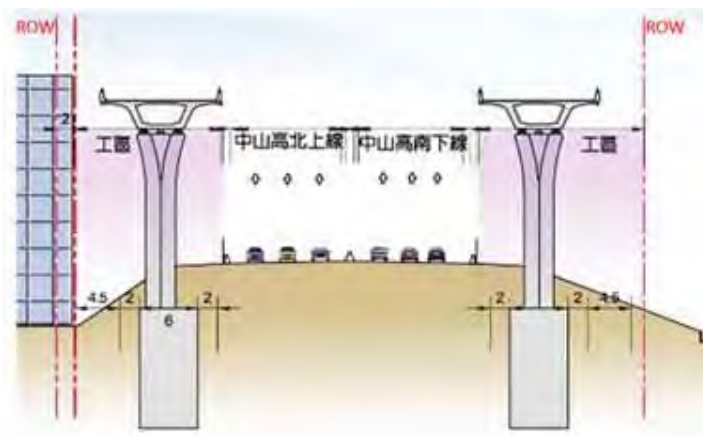
圖 8.1.2-3 路外段施工工區示意圖
