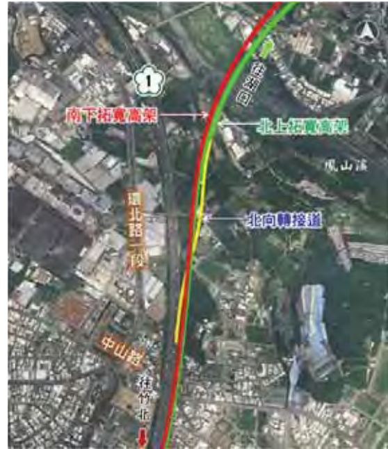
圖 8.5.2-1 竹北段單側雙層(A)路線布設示意圖
