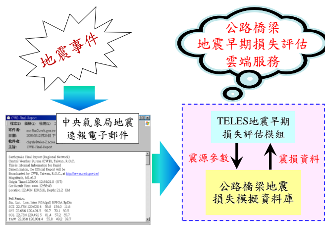
圖 5 公路橋梁地震早期損失評估及服務示意圖
