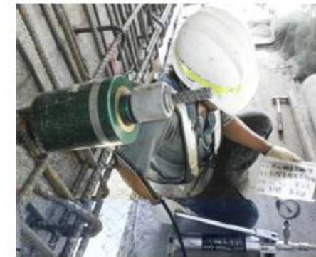
(d)植筋拉拔試驗照片
