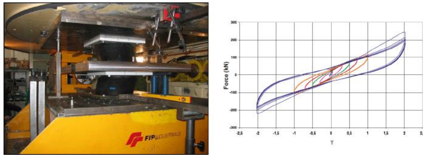
圖5: 測試中的彈性隔震裝置(右)和典型HDRB遲滯迴圈。
