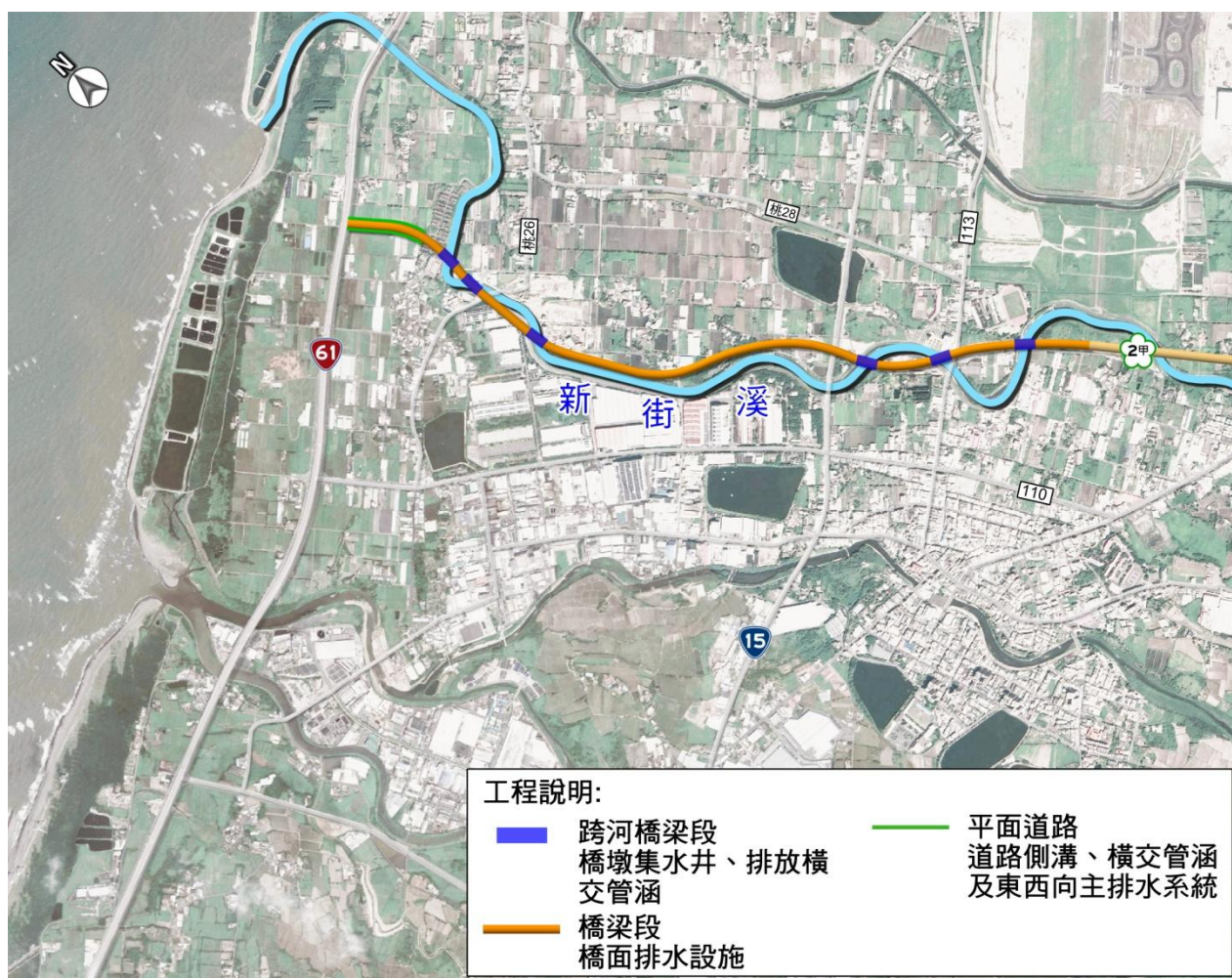
圖 6.3.4-1 新街溪路廊排水設施布置示意圖
