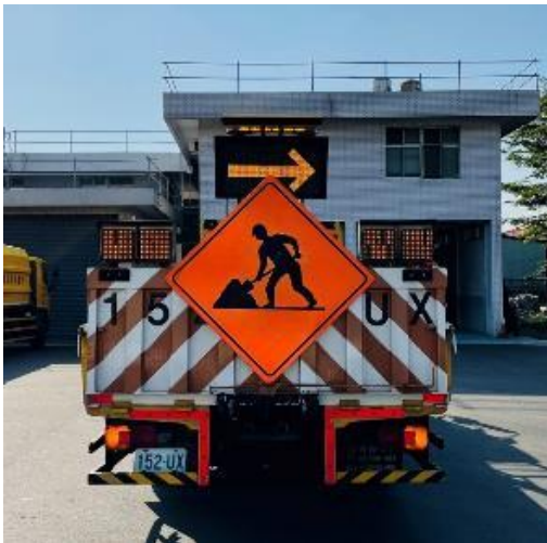
標誌車載式移動式 LED 標誌板相片例
