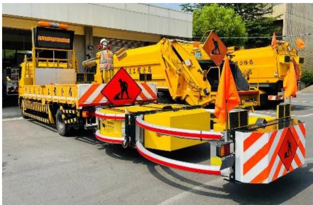
移動性施工標誌布設相片例
