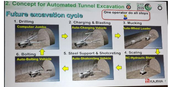
圖 41 未來施工開挖自動化(鹿島)
