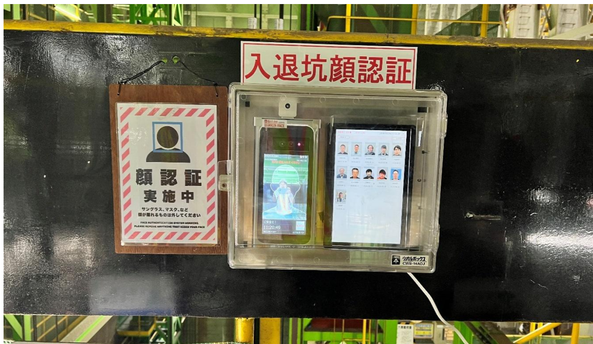
圖4-15 人臉辨識系統作為工地現場人員管制系統
