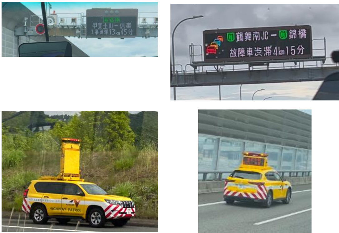
圖4-29 資訊可變標誌顯示方式
