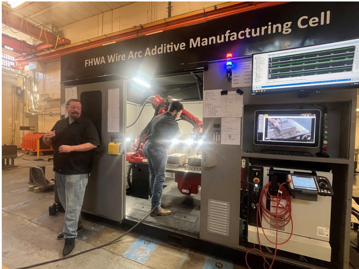
圖75 公路研究中心鋼添加物實驗室設備
