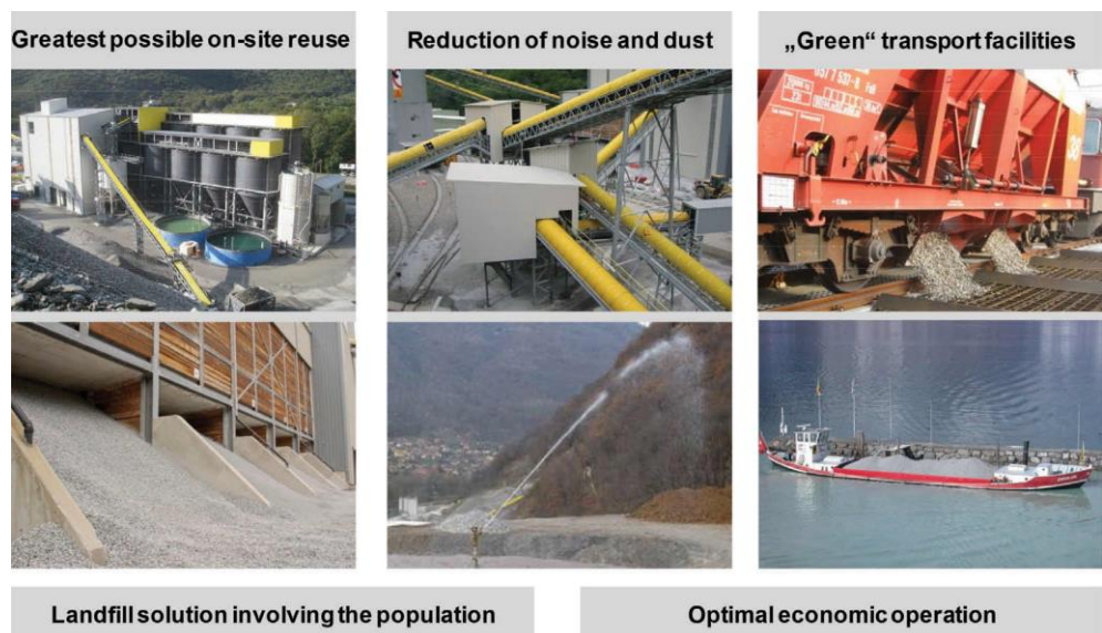
圖 4-12 Gotthard Base 鐵路隧道開挖碴料處理
