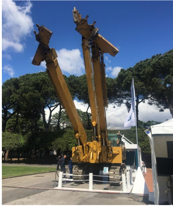
圖 4-23 鋼支保架設機
