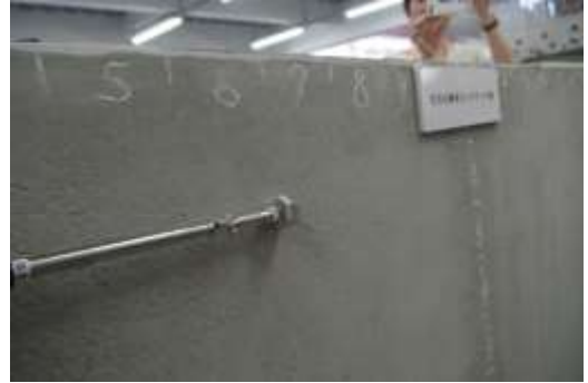
圖 3-35 滾動槌敲擊回音點檢測牆
