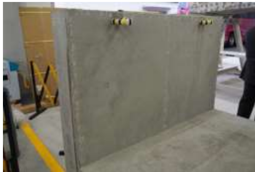
圖 3-36 敲擊回音點檢測法混凝土牆
