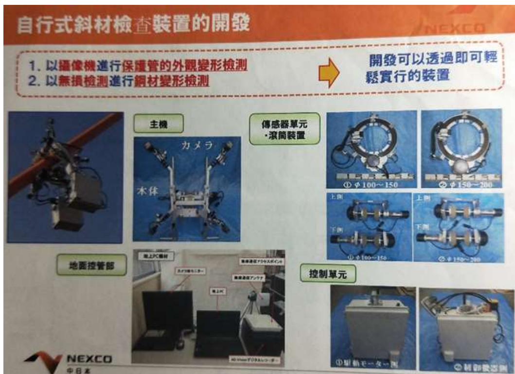
圖 3-65 自行式斜材檢查裝置器材組成
