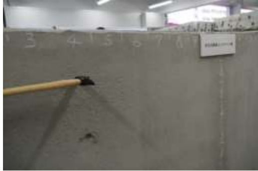
圖 3-34 鐵槌敲擊回音點檢測牆
