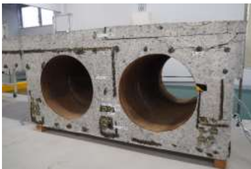
圖 3-25 橋梁結構中空橋面板模型
