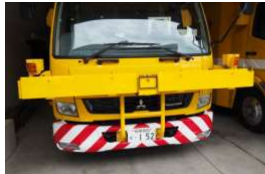
圖 3-39 Road Tiger 檢測車前方平坦儀
