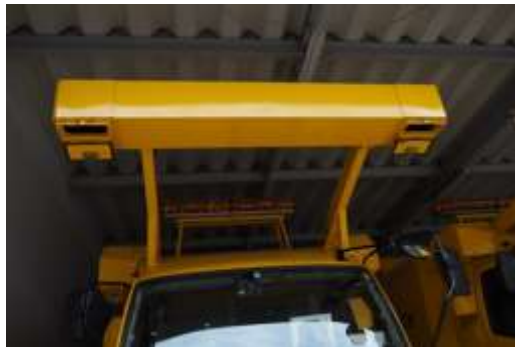
圖 3-38 Road Tiger 檢測車上方影像儀
