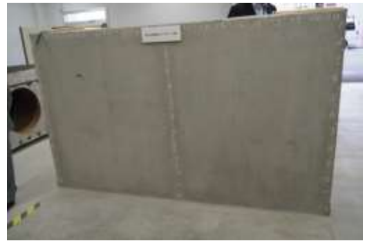
圖 3-36 敲擊回音點檢測法混凝土牆
