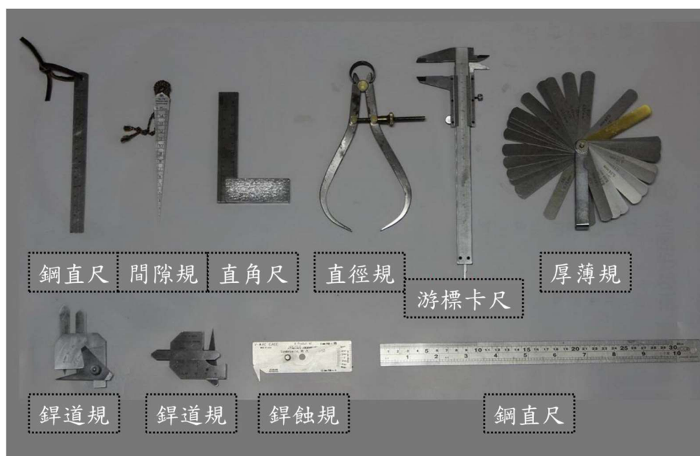
圖 2.4-4 箱梁內量測工具
