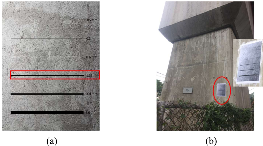
圖 2 採用輔助檢測工具(望遠鏡)之第 2 次實測標的物照片
