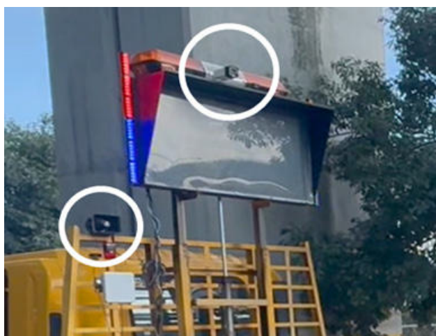
圖 5.26 緩撞車試辦加裝 AI 影像辨識攝影機及蜂鳴器
