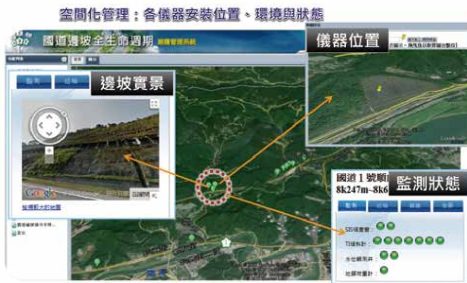
圖 3 國道邊坡全生命週期維護管理系統 3D 圖台畫面
