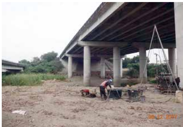
第 M37B 標 獅子頭溪河川橋補充地質鑽探
