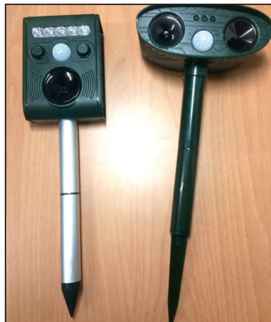
利用超音波、燈光、聲音驅趕動物的裝置。
