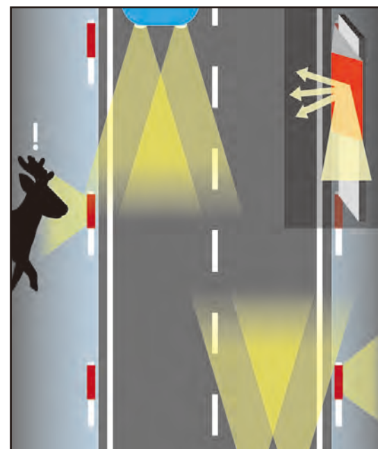
防道路致死反射裝置示意圖，能透過反射車燈達到警示動物的目的。
