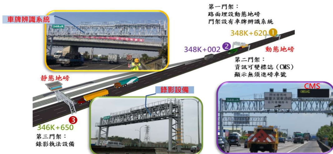
圖 4.1.11 主線篩選式動態地磅系統運作說明
