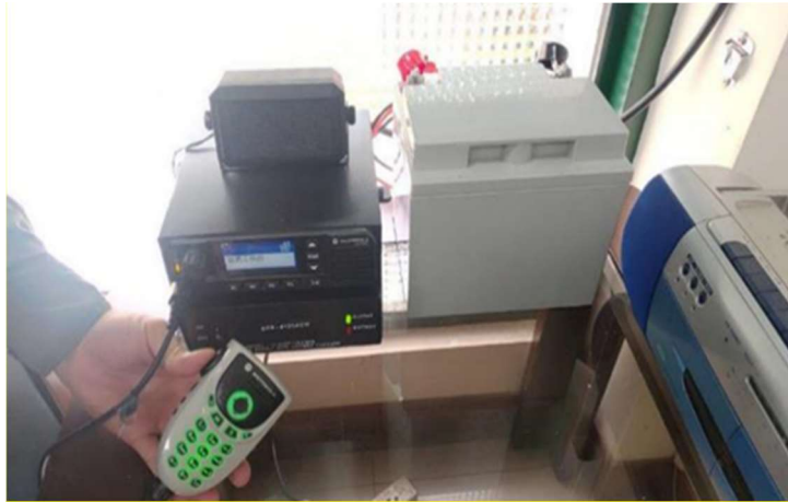
圖 4.1.12 固定臺測試（呼叫測試）
