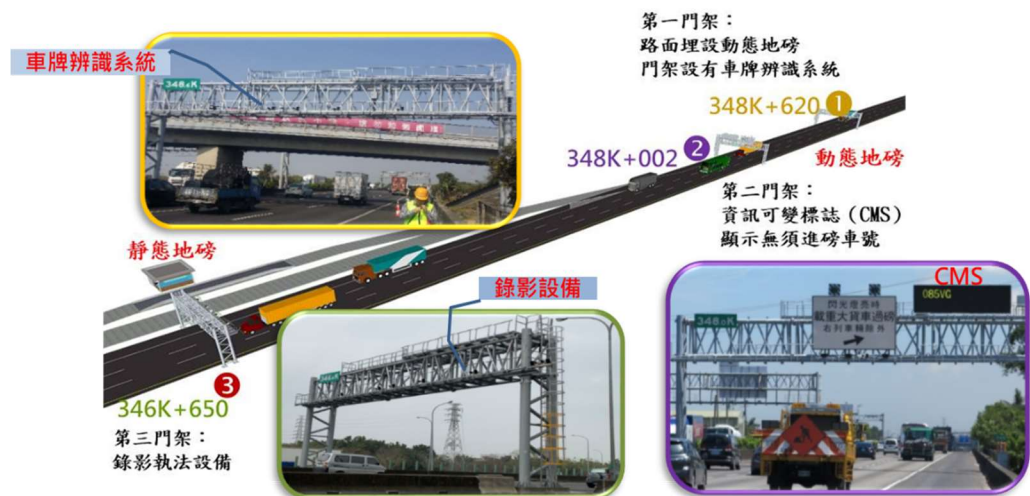
圖 4.1.9 主線篩選式動態地磅系統運作說明
