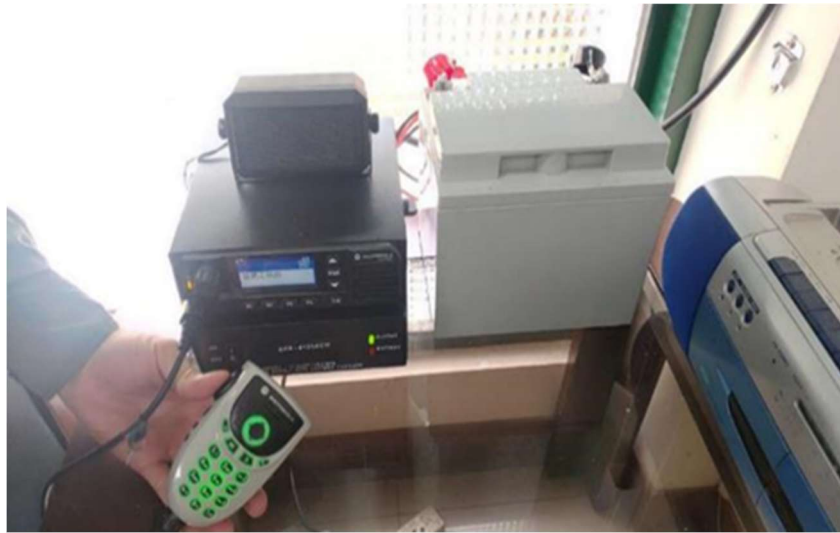
圖 4.1.10 固定臺測試（呼叫測試）
