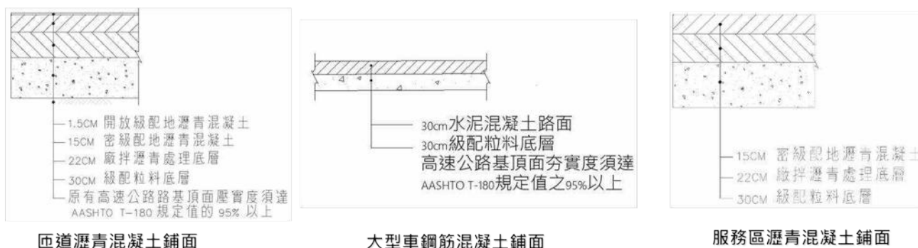
圖5.2 路面結構配置示意圖
