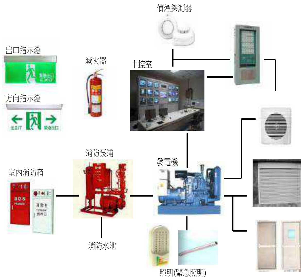
圖4.36 消防系統流程圖
