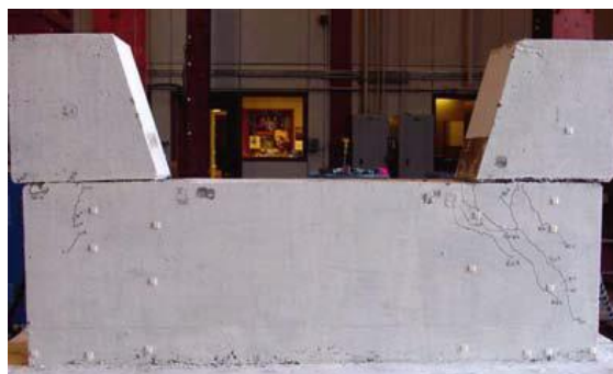
(b) 止震塊「控制性」損壞模式
