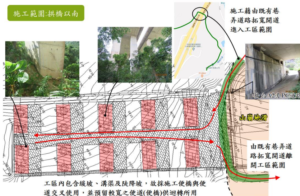
圖 5 支承補強施工便道、便橋配置示意圖(拱橋以南)
