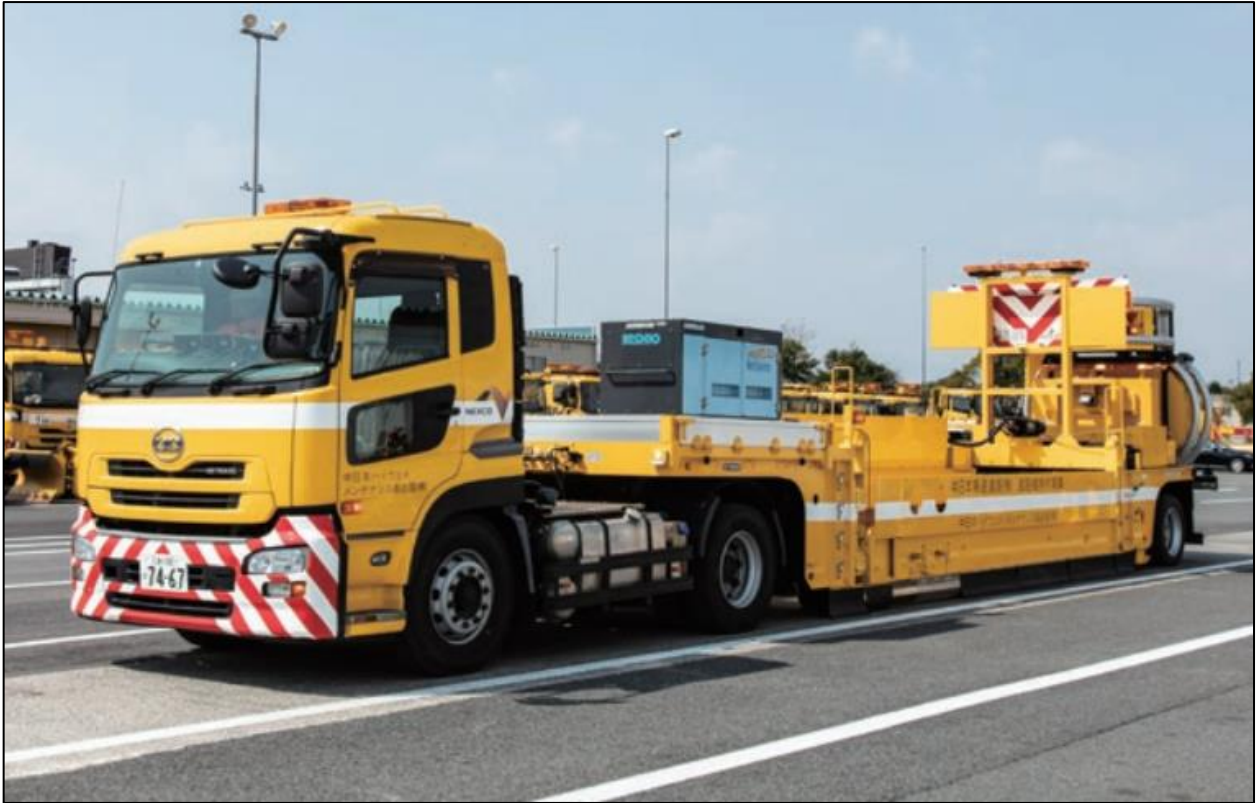
圖 67、大型移動式防護車輛外觀
