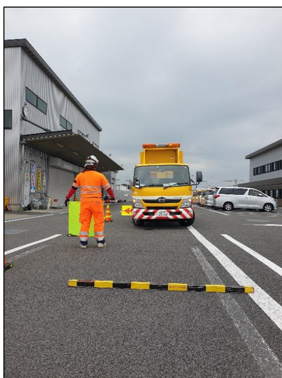
圖 102、「倒車警示防護桿」配置情形
