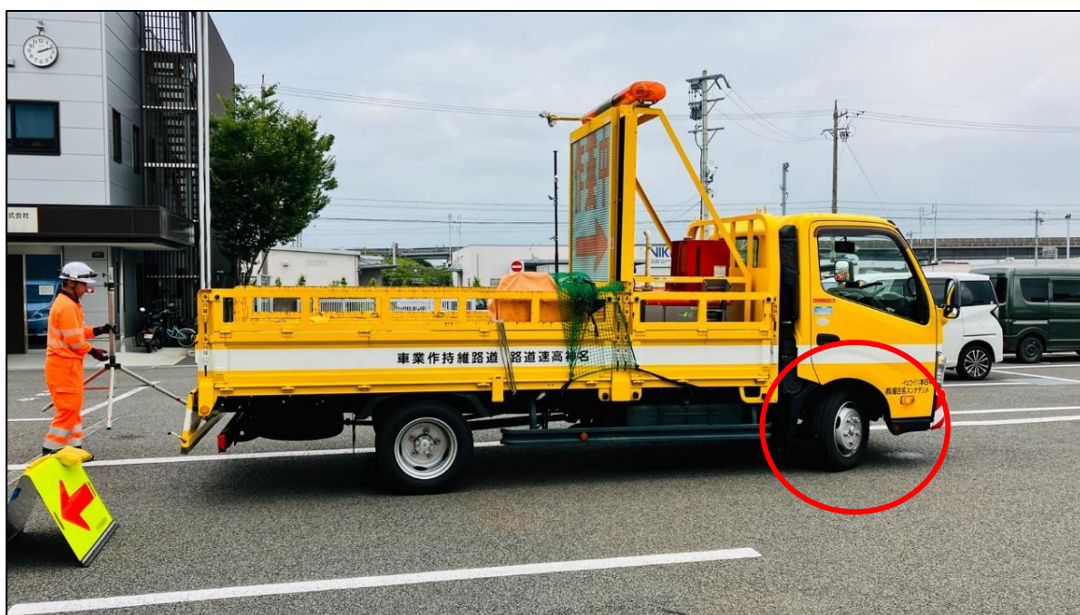
圖 98、施工車輛將車輪方向打斜
