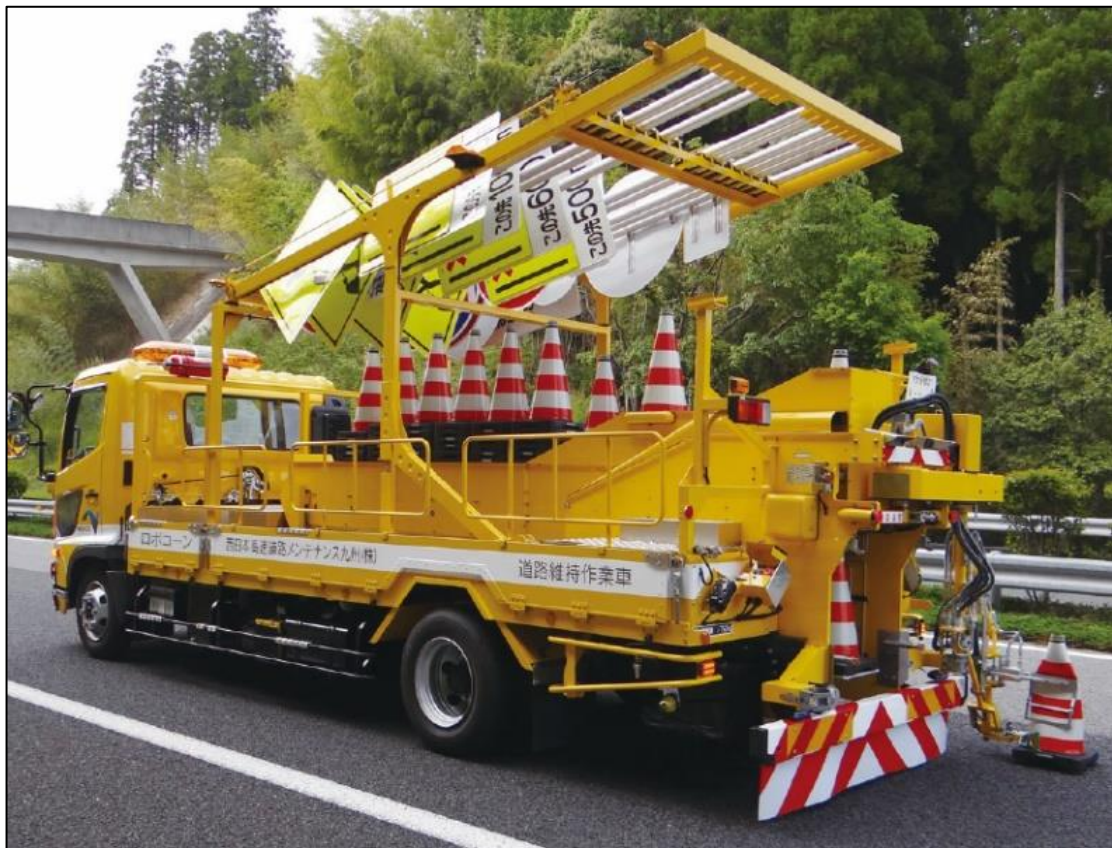
圖 90、交通錐及標誌牌面自動設置及回收車
