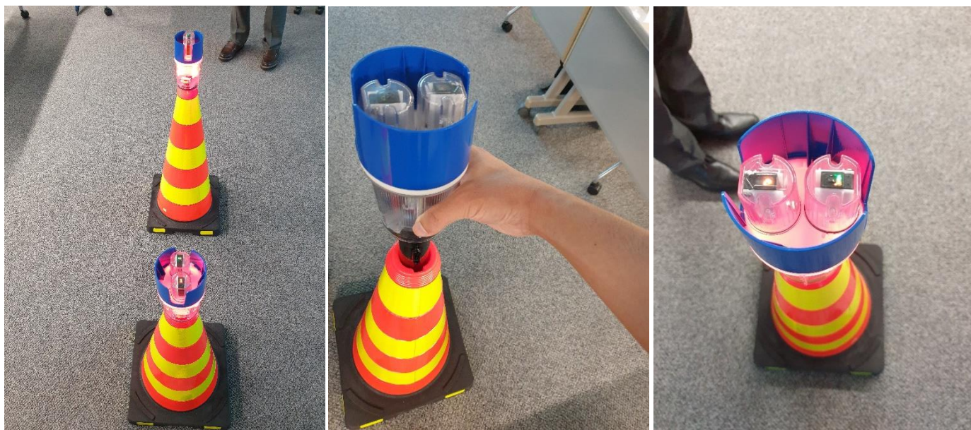
圖 80、自發光型入侵緊急通報系統
