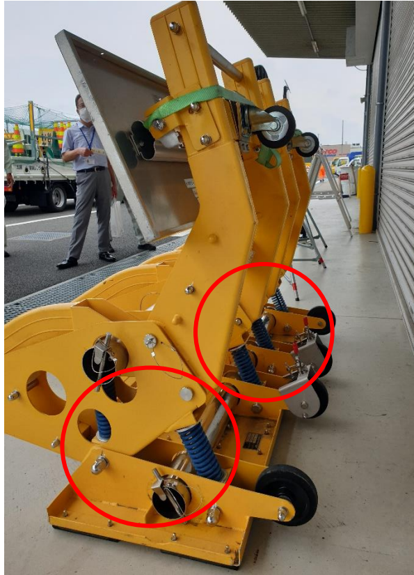
圖 84、進入車輛停止裝置配備 8 個減震器
