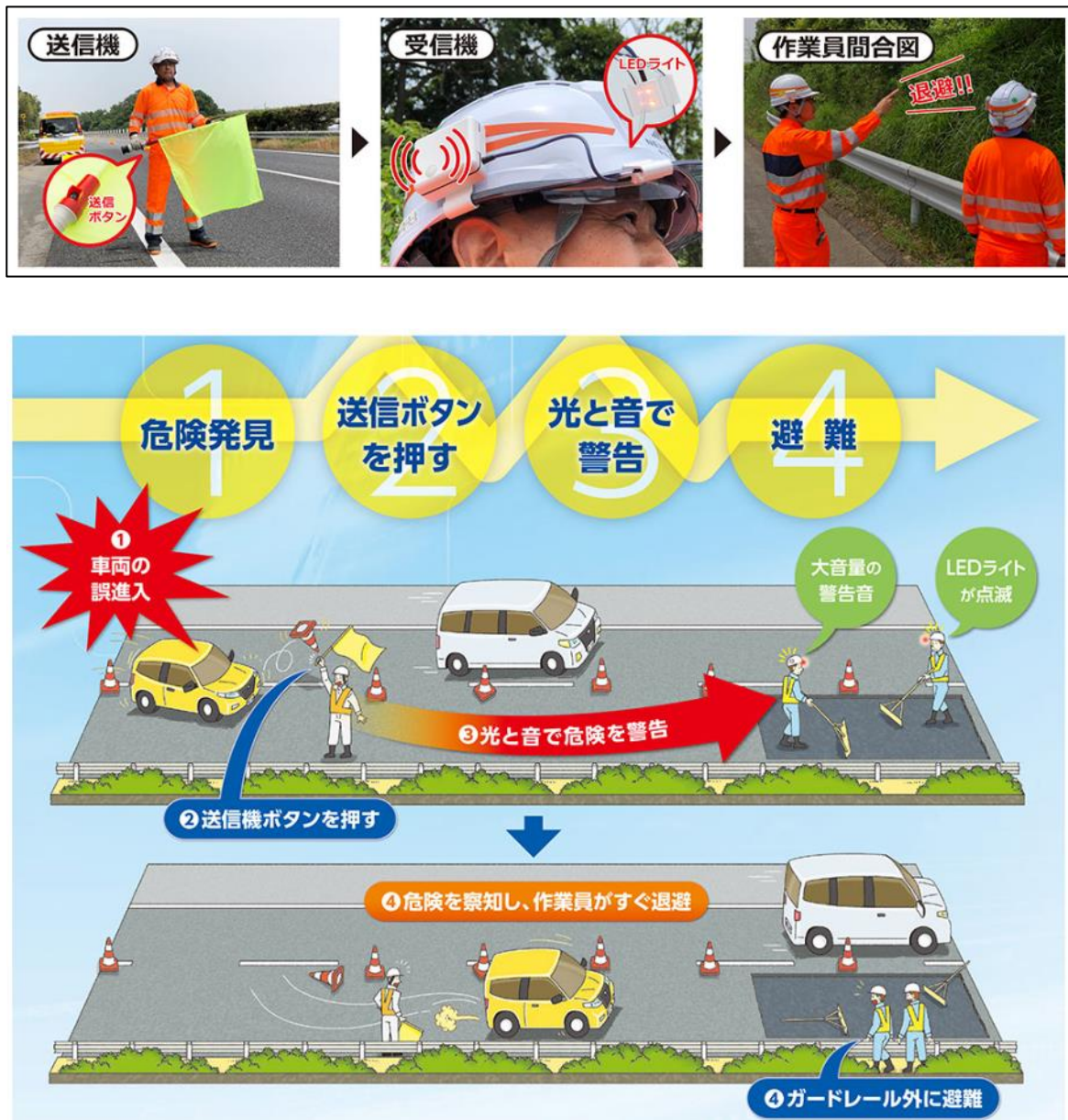
圖 76、緊急避難信號發射/接收系統運作示意圖
