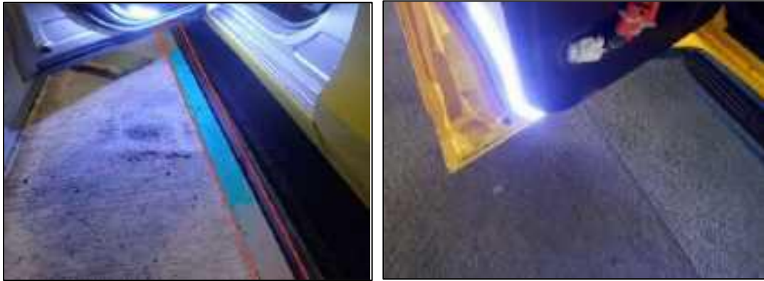
圖 21、於巡邏車之車門安裝 LED 燈以提升隧道和夜間下車時之能見度
