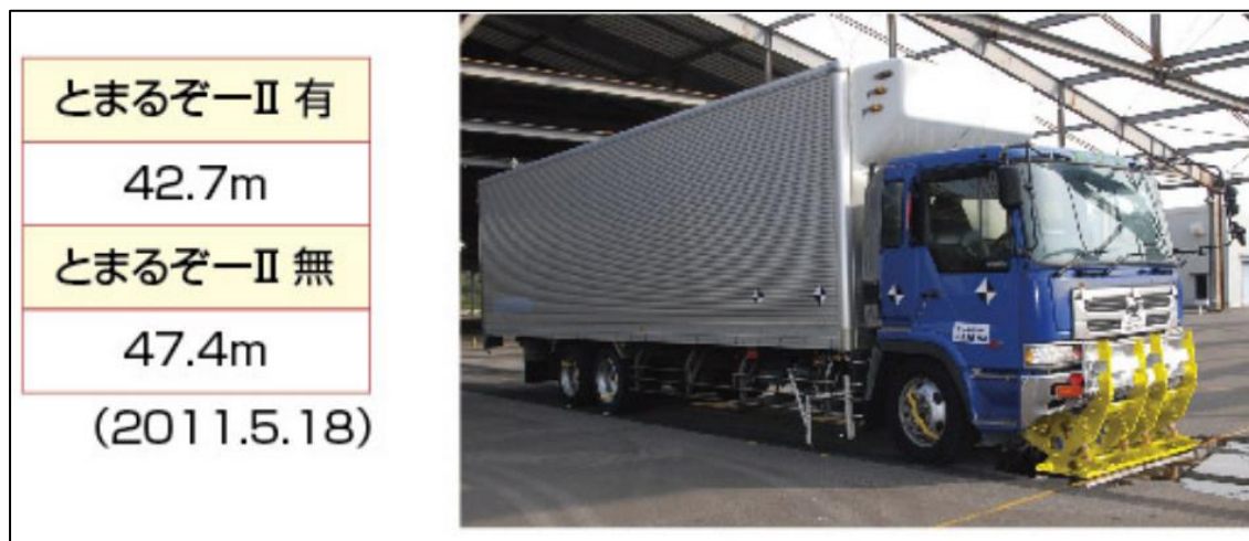
圖 83、進入車輛停止裝置實驗數據
