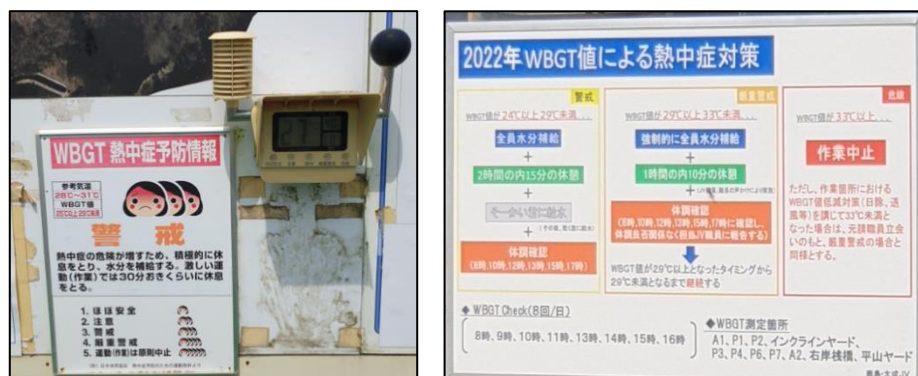
圖 138、設置 WBGT 綜合溫度熱指數計及管理標準
