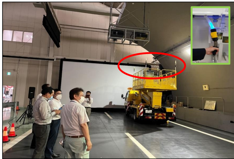
圖 113、高空工作車配置「被夾警示棒」
