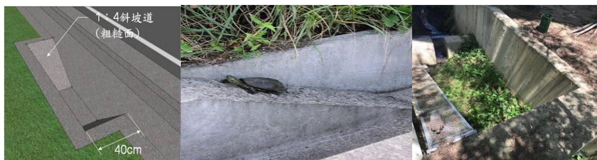
圖 4.7.1-11 不同型式的動物逃生坡道示意圖
