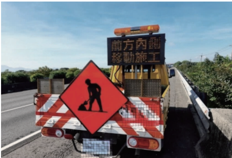
圖 3.6-9 外側路肩預告標誌車 ( 再次提醒施工影響之車道 )
