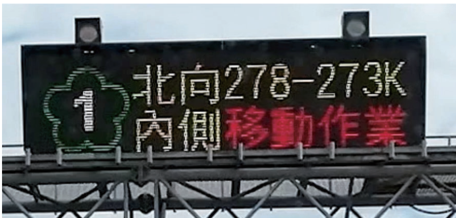
圖 3.6-8 CMS 顯示之施工資訊 ( 包含施工位置及工項 )
