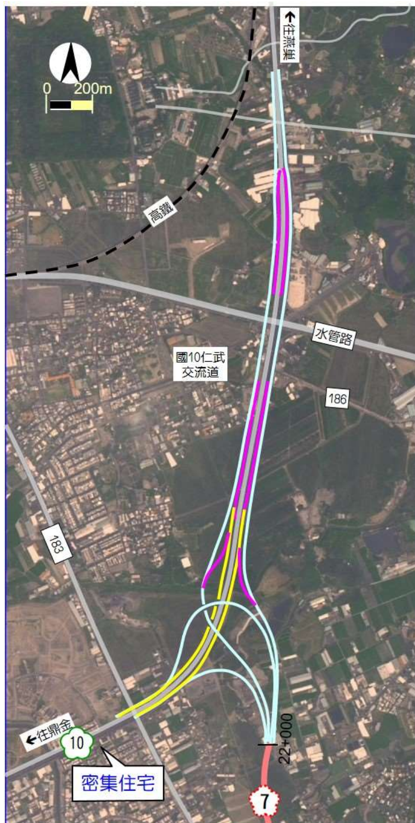
圖 4. 1. 1-13 仁武系統交流道 Y 型方案(左進左出)
