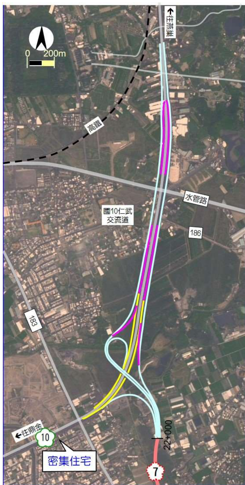
圖 4.1.1-14 仁武系統交流道喇叭型方案(左進左出)
