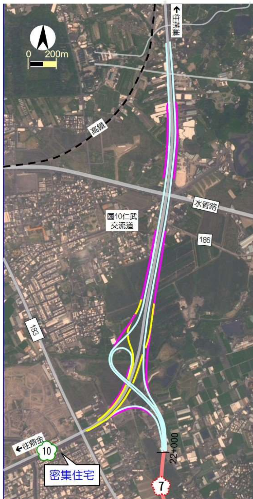
圖 4. 1. 1-17 仁武系統交流道喇叭型方案 (增設 183 縣道服務性匝道)
