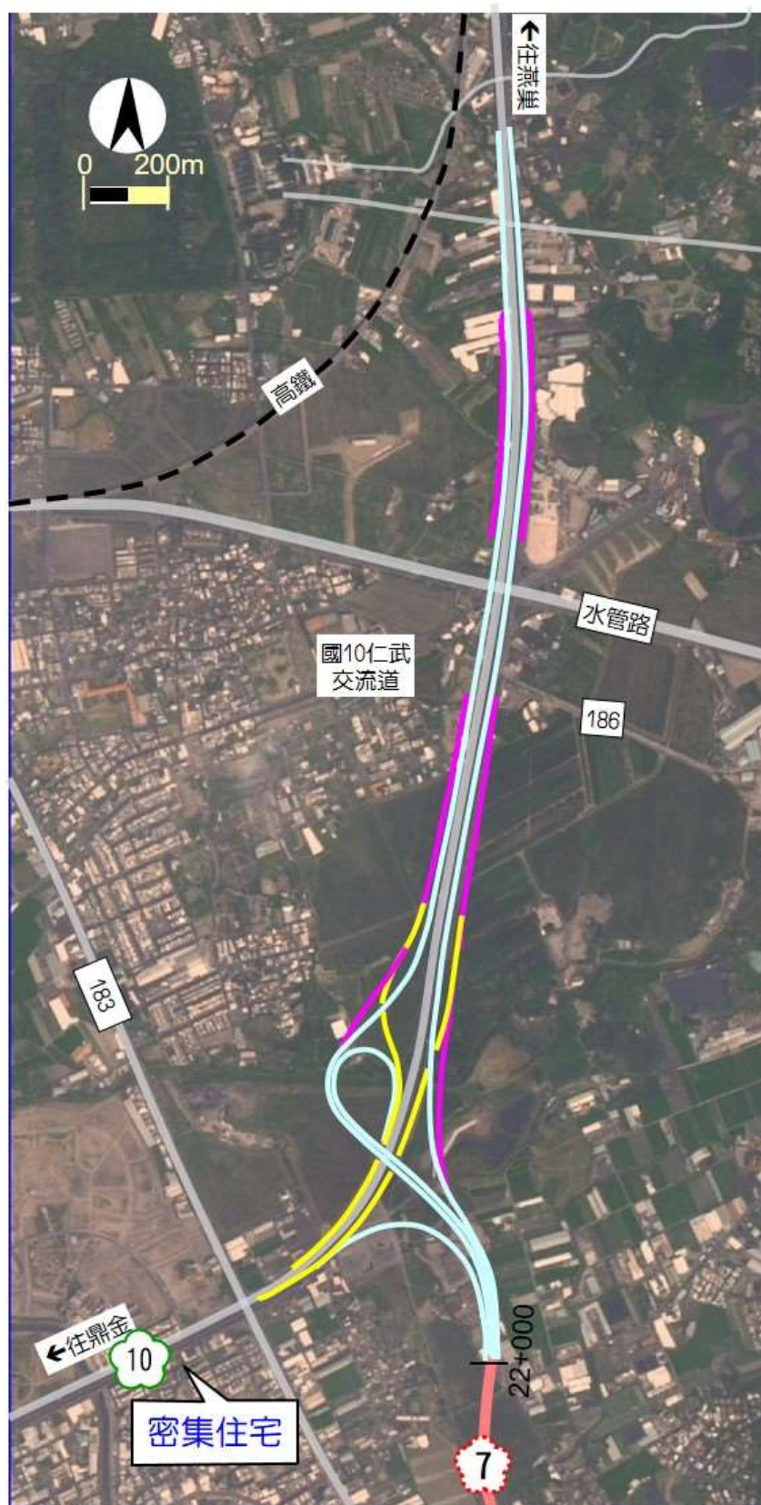
圖 4. 1. 1-16 仁武系統交流道喇叭型方案(右進右出)
