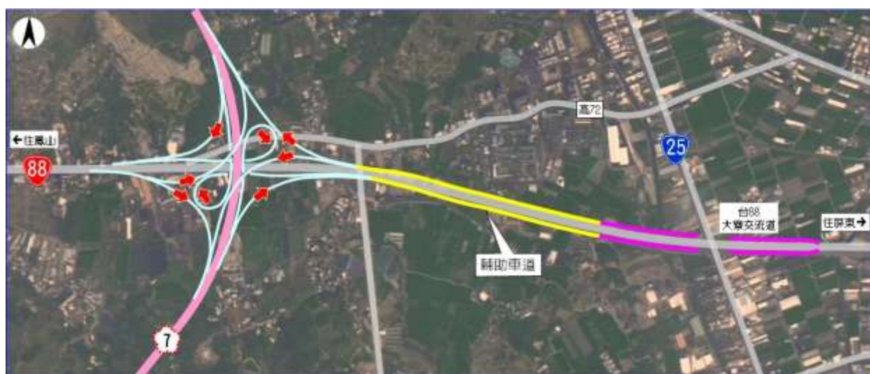
圖 4.1.1-8 大寮系統交流道半交疊式之半苜蓿葉型方案
