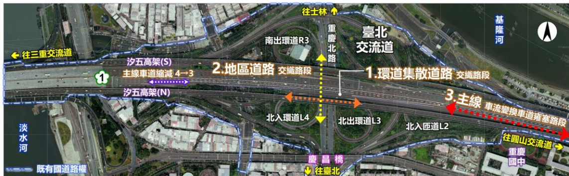
圖 3.4-1 臺北交流道車流交織路段平面示意圖
