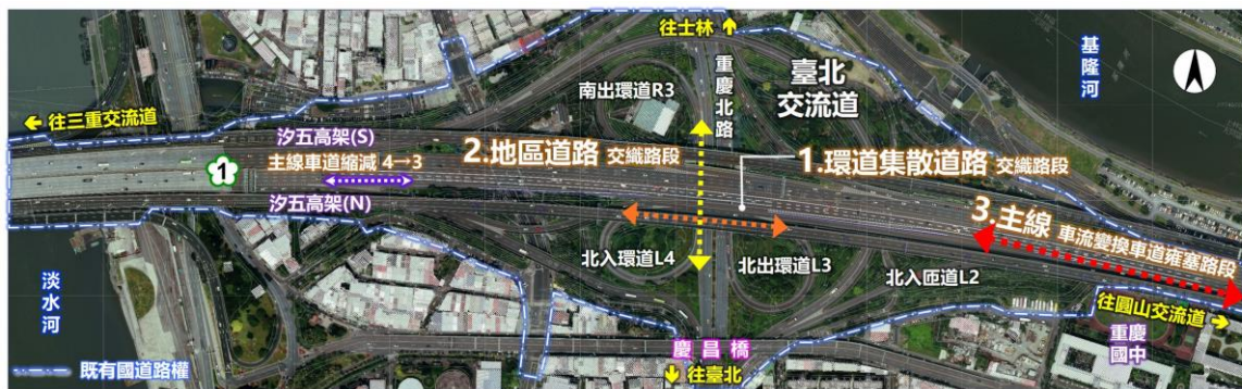
圖 1.1-1 臺北交流道車流交織路段平面示意圖
