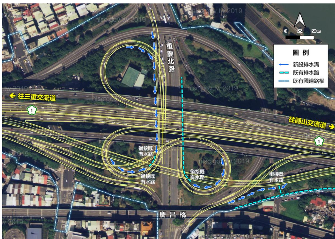
圖 4.1-5 臺北交流道排水系統規劃平面圖
