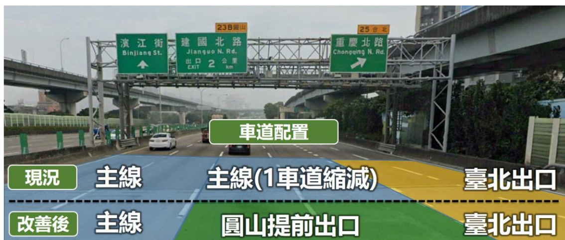
圖 3.4-3 臺北交流道改善前後北出匝道前主線車道配置示意圖
