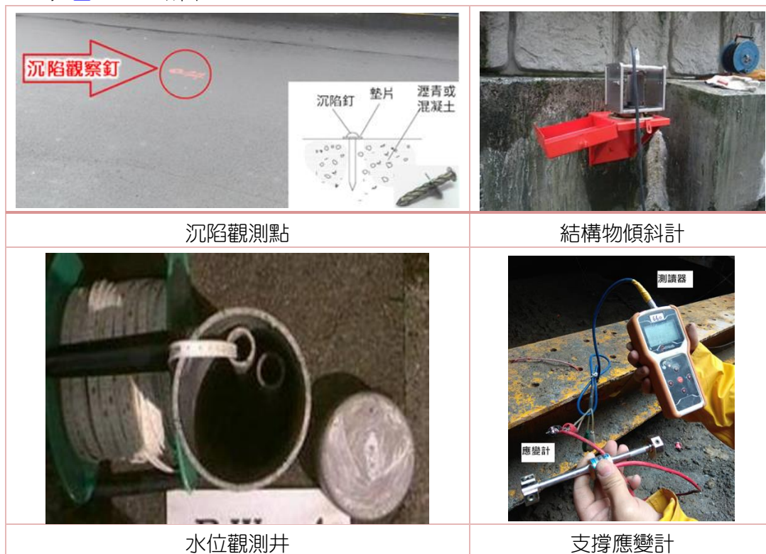
圖 4. 1-25 沉陷監測儀器
