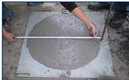
自充填混凝土具高流動性
