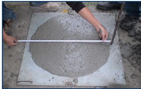
自充填混凝土具高流動性
