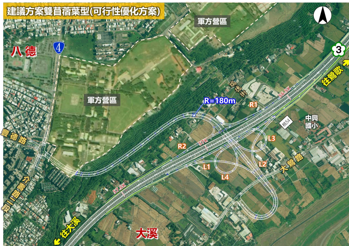
圖 3.3.1-1 建議方案雙苜蓿葉型交流道平面示意圖
