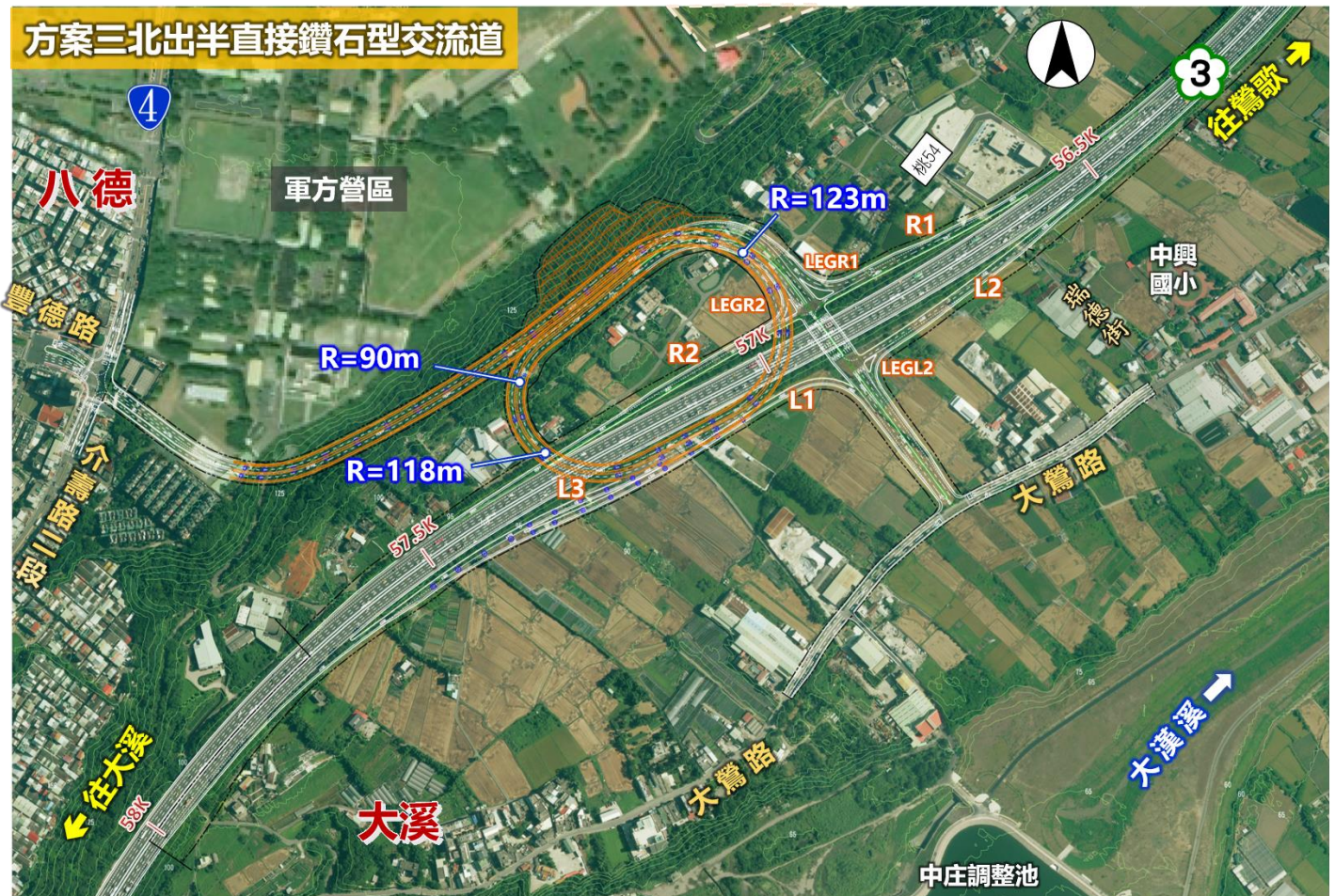
圖 3.1-1 方案三北出半直接式鑽石型交流道平面示意圖
