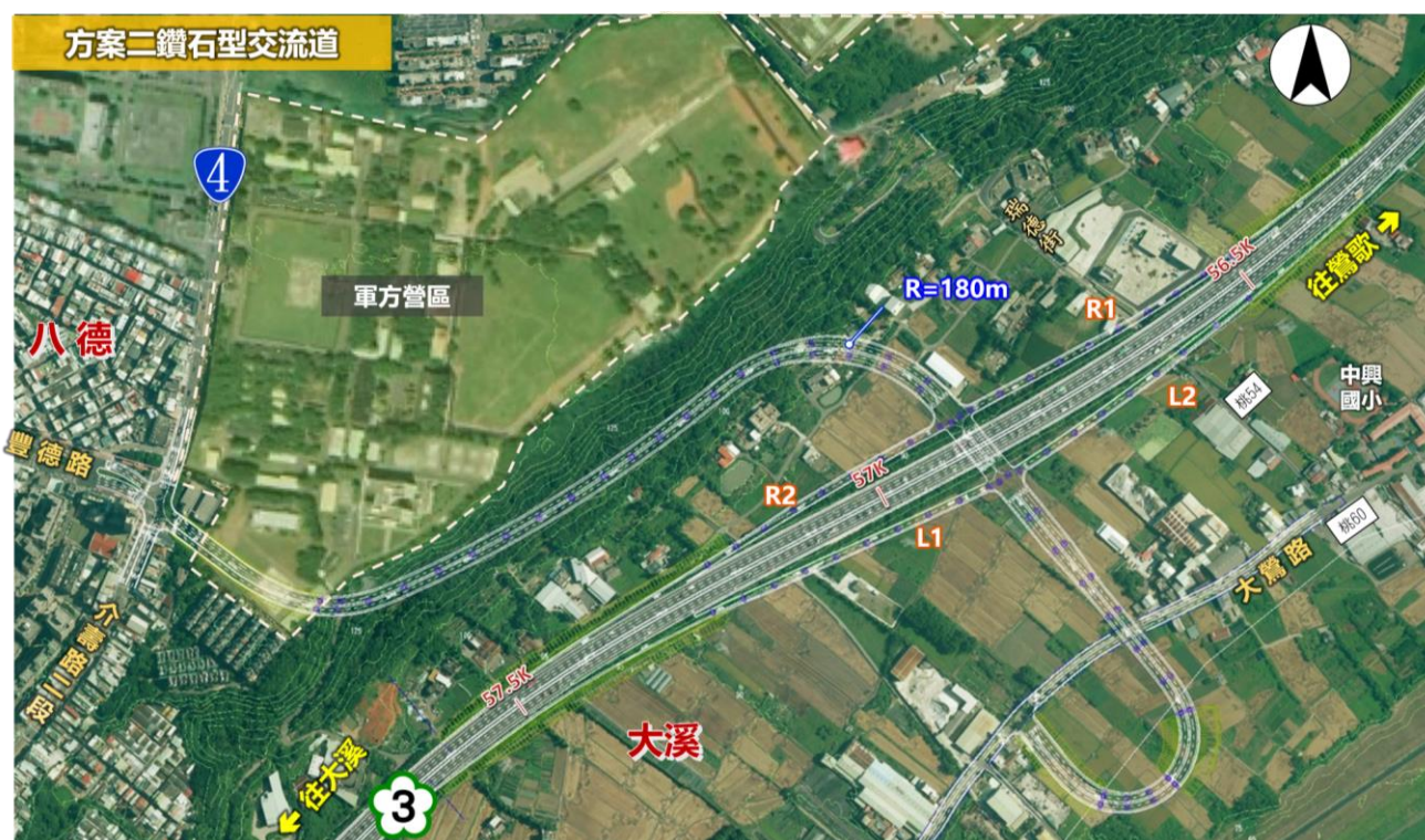
圖 2.1-1 方案二鑽石型交流道平面示意圖
