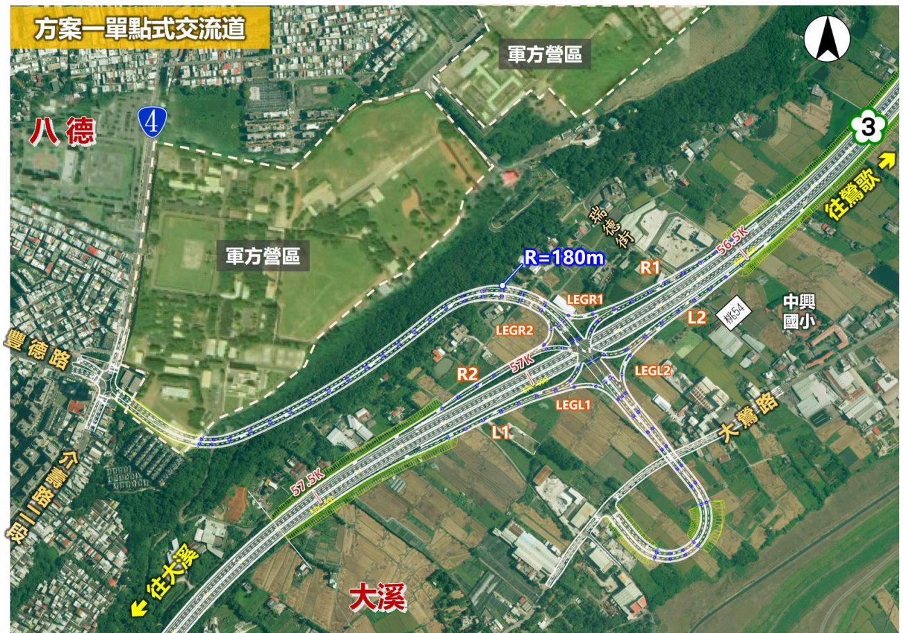
圖 1.1-1 方案一、單點式交流道平面示意圖
