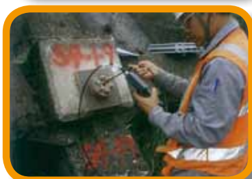
圖 4 地錨功能檢測照片
