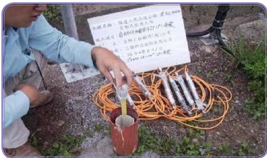
圖 2 自動化傾度管裝設情形
