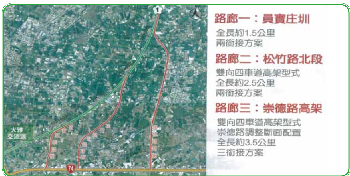
國 1 台中路段增設系統交流道接台 74 線路廊示意圖
