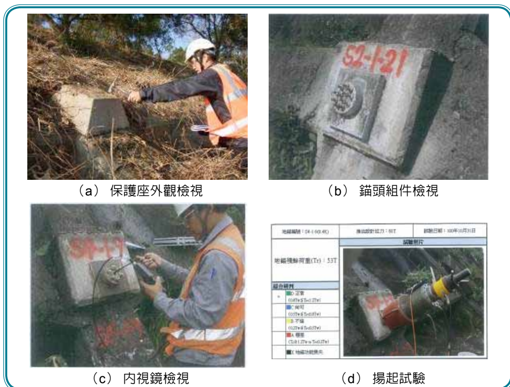
圖 4 地錨功能檢測照片
