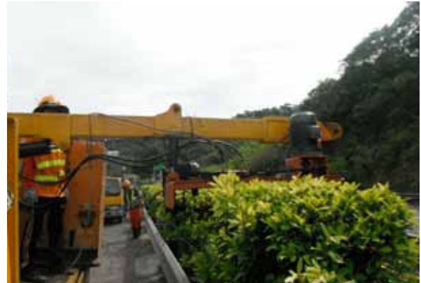
國道 1 號 36-39k 中央分隔帶小葉榕以半自動機械修剪情形
