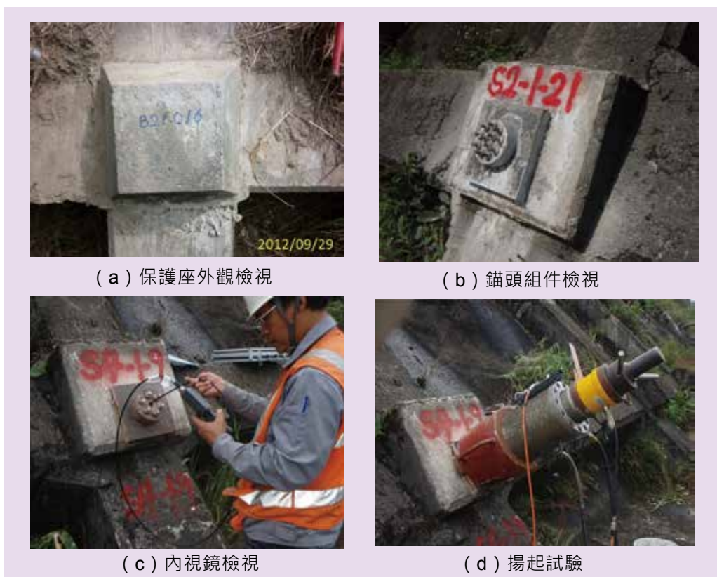
圖 4 ▲地錨功能檢測照片
