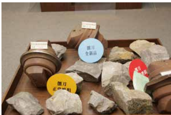
▲合金鋼製全斷面隧道鑽掘機所使用之 削刀 (2015.01.12)
