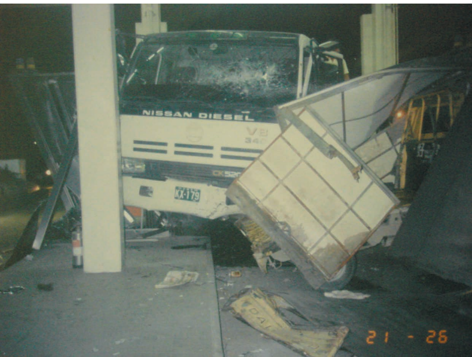
時有大車失速衝撞收費亭，之後於票亭前設置護墩及緊急滑行道
