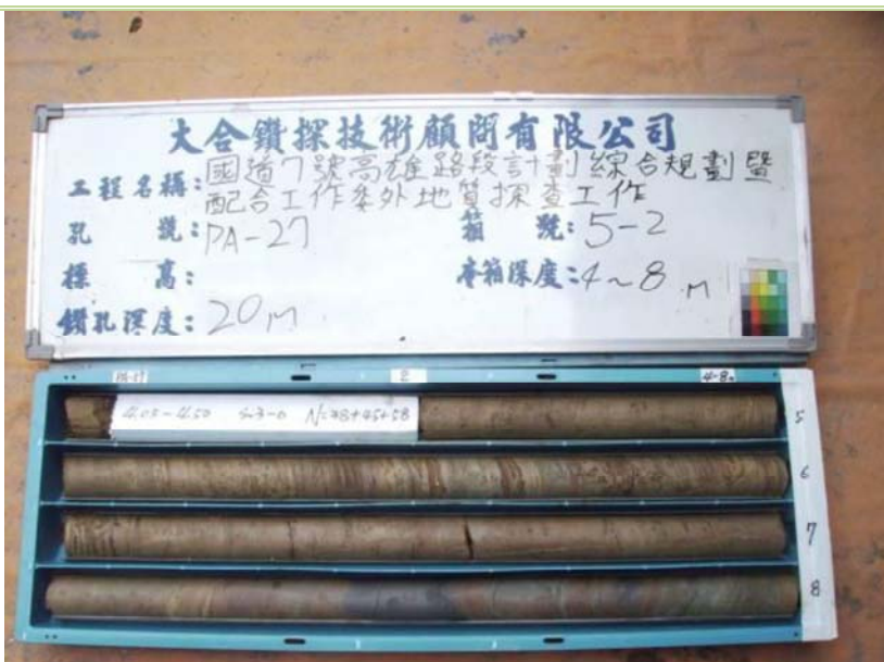
PA-27 鑽孔岩心箱照片(4.00 M ~ 8.00M)
