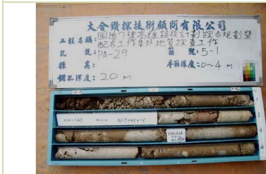
PA-29 鑽孔岩心箱照片(0.00 M ~ 4.00M)
