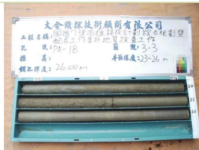
PA-18 鑽孔岩心箱照片(23.0 M ~ 26.0M)
