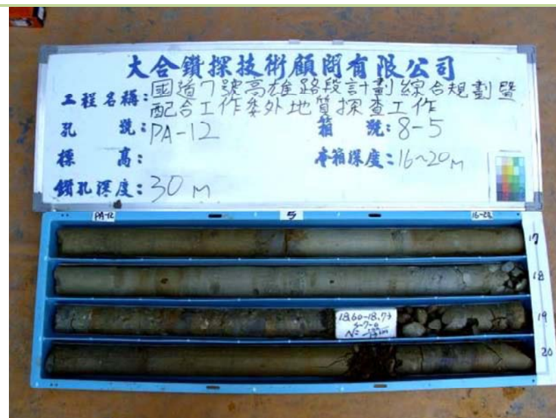
PA-12 鑽孔岩心箱照片(16.0 M ~ 20.0M)
