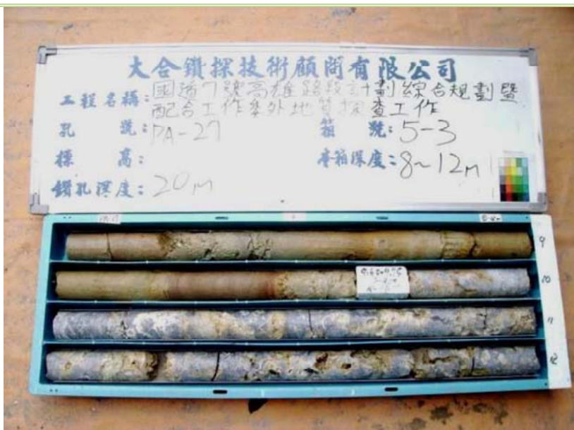
PA-27 鑽孔岩心箱照片(8.00 M ~ 12.0M)
