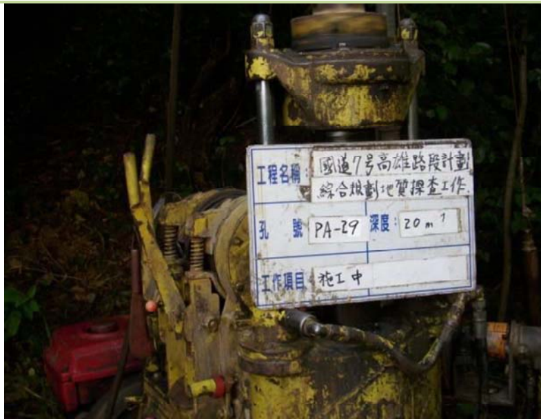
PA-29 號鑽探孔現場鑽探照片(施工中)
