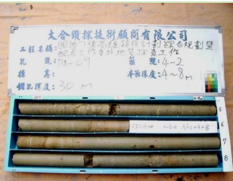
PA-09 鑽孔岩心箱照片(4.00 M ~ 8.00M)
