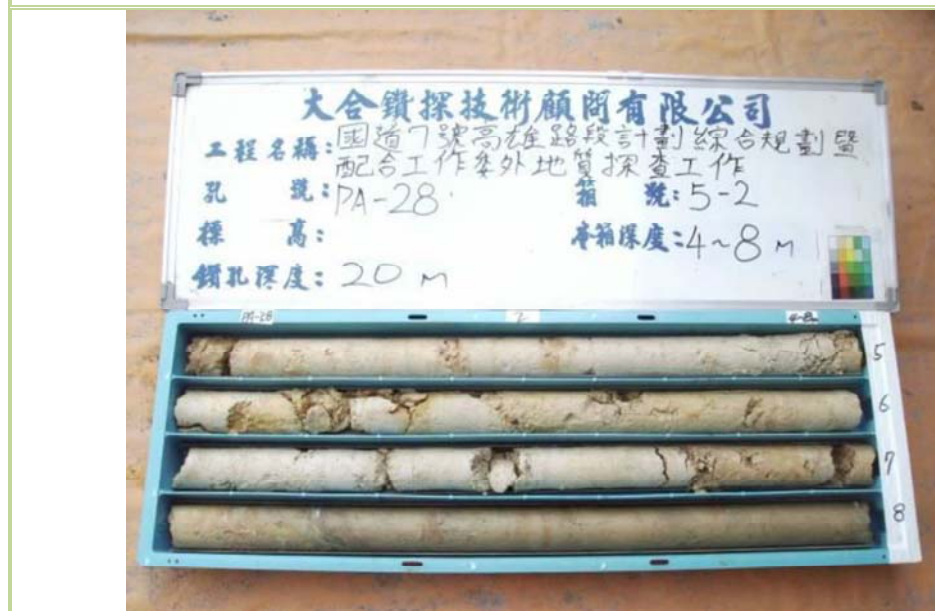
PA-28 鑽孔岩心箱照片(4.00 M ~ 8.00M)
