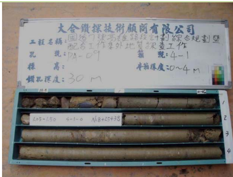
PA-09 鑽孔岩心箱照片(0.00 M ~ 4.00M)
