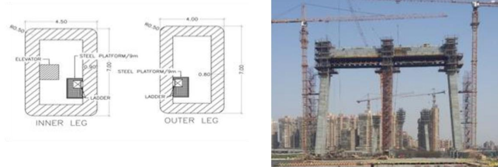
圖 3-33 橋塔橫斷面及自爬升式模板
