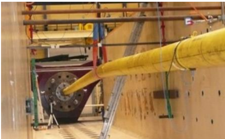
圖 3- 23 鋼纜疲勞試驗設備彎曲應力試驗
