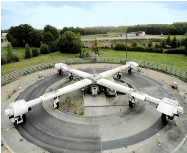
圖 3-20 路面疲勞試驗軌道
