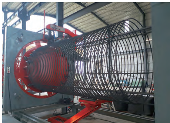
第 C715 標 箍筋籠成型加工
