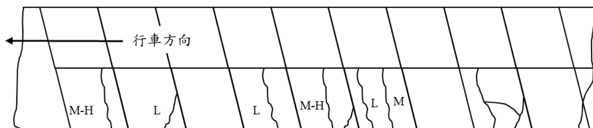
(a) 損壞型式：L：輕微，M：中等，H：嚴重
