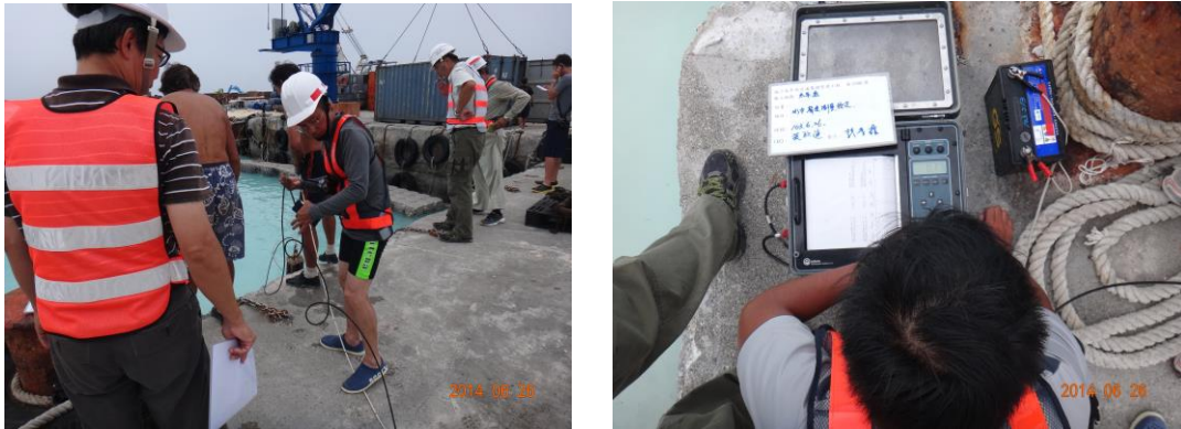
圖 8-5 水深測量聲速律定
