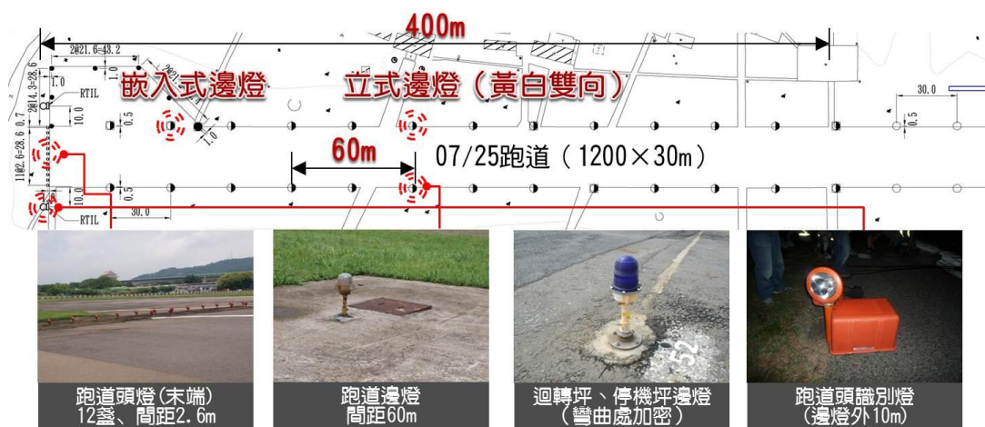
圖 3-35 機場助航燈光系統配置
