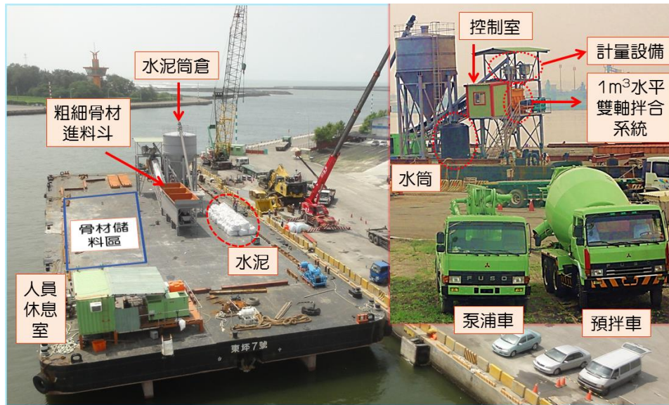
圖 11-5 東坪 7 號平台船裝載拌和設備
